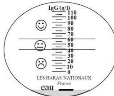
Nouveau colotest (2005), Étalonnage à l'eau déminéralisée au niveau « eau »
